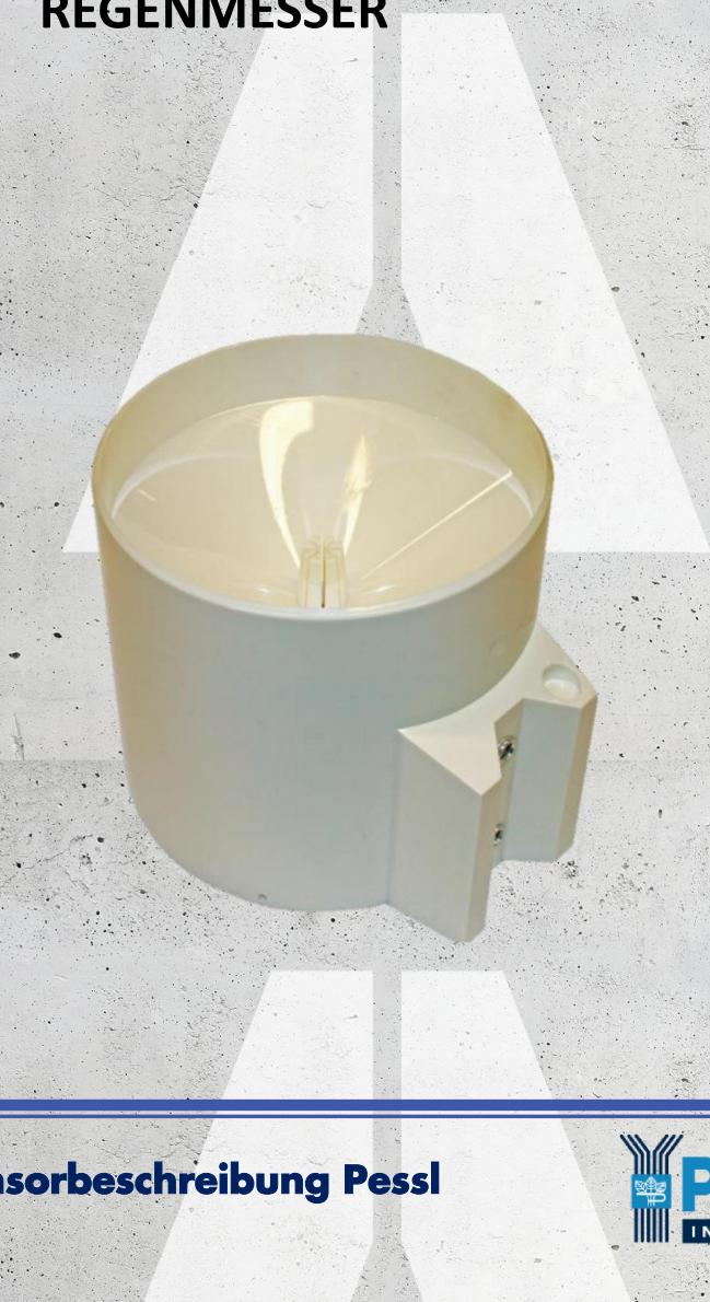
Der Mechanismus besteht aus einem Magnet, der sich an einem Reed-Kontakt vorbeibewegt und somit den Stromkreis öffnet oder schließt. Der Doppellöffel (Wippe) kippt nach links oder rechts und verliert durch eine sehr schnelle Schaltmechanik kein Wasser. Die Auflösung bei einer Fläche von 200 cm<sup>2</sup> beträgt 0,2 mm, während die Auflösung bei 80 cm<sup>2</sup> 0,5 mm beträgt. Zusätzlich kann eine Heizung für den Regenmesser integriert werden.
