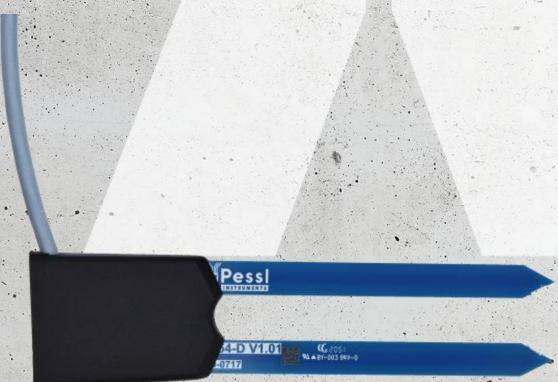
Der Bodenfeuchtesensor PI54-D hat einen größeren Einflussbereich. Er bestimmt den volumetrischen Wassergehalt (VWC) durch Messung der Dielektrizitätskonstante des Bodens mit Hilfe der Kapazitäts-Technologie und der Bodentemperatur. Er ist 10 cm lang und misst somit 1 Liter Boden, während die hohe Frequenz den Salzgehalt und die strukturellen Auswirkungen minimiert, was den PI54-D in den meisten Böden genau macht.
